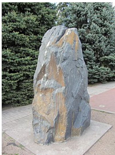
Кварцит магнетитовый тонкослоистый мелкозернистый джеспеллитовый (Анновский карьер, Кривбасс) в музее горной техники СевГОКа
